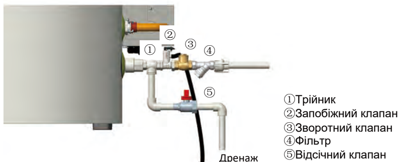
Режим 2 монтажу клапана водопровідної води (тиск води на вході <0,1 МПа)
