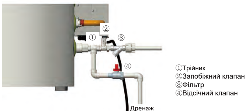
Режим 1 монтажу запобіжного клапана водопровідної води (тиск води на вході =0,1~0,5 МПа)
